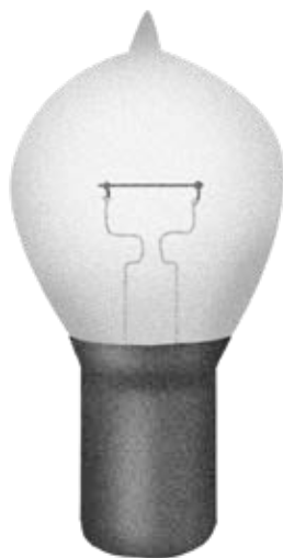
Lâmpada de Swan com vareta de grafite como elemento incandescente.
