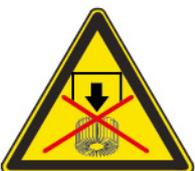
Não coloque o driver ou qualquer outro objeto sobre o dissipador. Os dissipadores necessitam trabalhar livremente sem a interferência de qualquer obstáculo.
