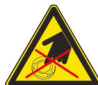
Não tocar na parte do fósforo (parte amarela). A superfície de fósforo dos módulos e réguas é extremamente sensível a qualquer contato mecânico. Evite qualquer pressão ou contato com a superfície de iluminação. Não use nenhum produto ou objeto para limpar o LED (água, panos, entre outros).
